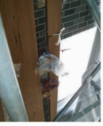
【各種測定の実施】 暑熱環境測定：熱電対・熱流計 気象状況測定：風向・風速・温度 湿度・日射・放射 (大阪府立大学吉田研究室による)
