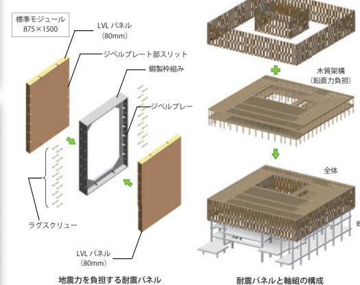
木材を耐火被覆した場合、木材が見えなくなる。そこで、耐火被覆を必要としない耐震パネル(LVL・鋼製枠組み)を建物外周に配置することで「見える化」を実現した。室内から目で見え、直接手で触れられ、建築主が木造に求める木材特有のぬくもりを感じらる、どの部屋からも採光、通風を確保できるものとした。
