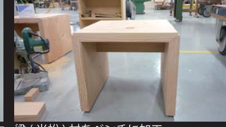
梁 (米松) 材をベンチに加工
