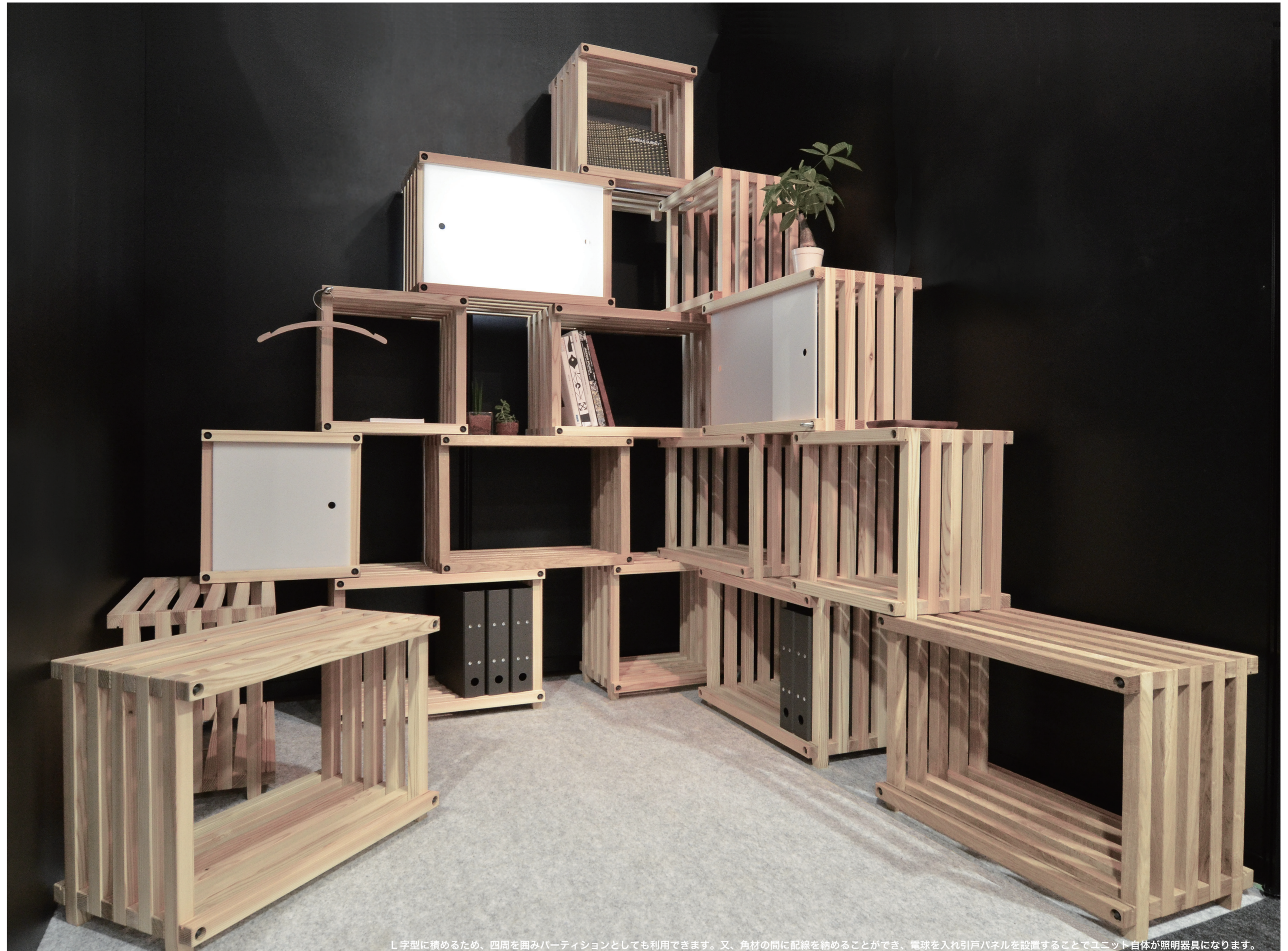
L字型に積めるため、四周を囲みパーティションとしても利用できます。又、角材の間に配線を納めることができ、電球を入れ引戸パネルを設置することでユニット自体が照明器具になります。
