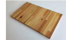
津波で倒木した材を利用したアカマツ、クロマツ集成材
