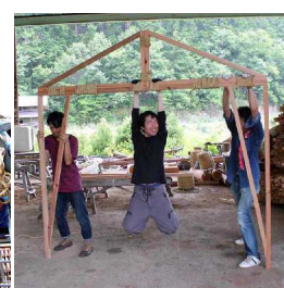
荒縄縛りによる接合 祇園祭の鉾にも使われる結び方「男結び」 大人がぶら下がっても大丈夫
