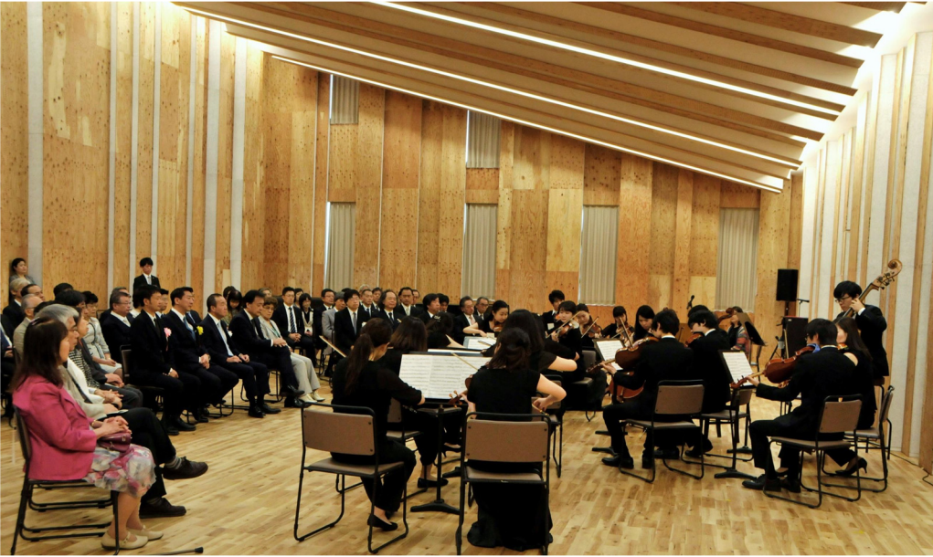
●特大講義室 集成材の大梁を採用することにより14m×23mの大空間を実現
